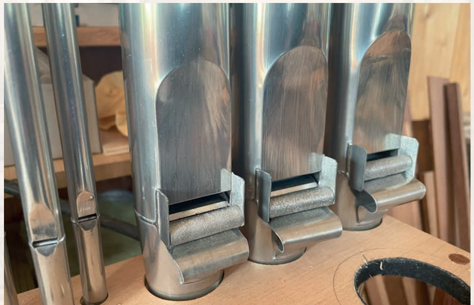
Detailaufnahme der neuen Pfeifen des Suavial 8' mit aufgelöteten Gavioli-Bärten
