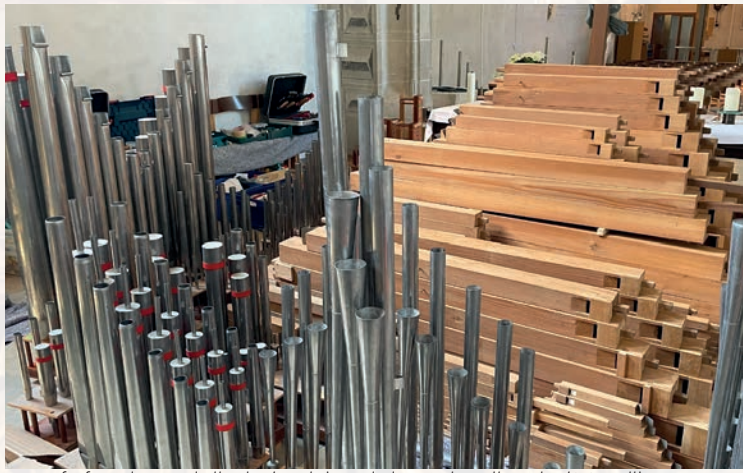
Die Pfeifen der Pedallade (Holz) und des Schwellwerks (Metall), gut zu sehen die Rohrflöte 4' mit kleinen Strohhalmen und befilzten Hüten.
