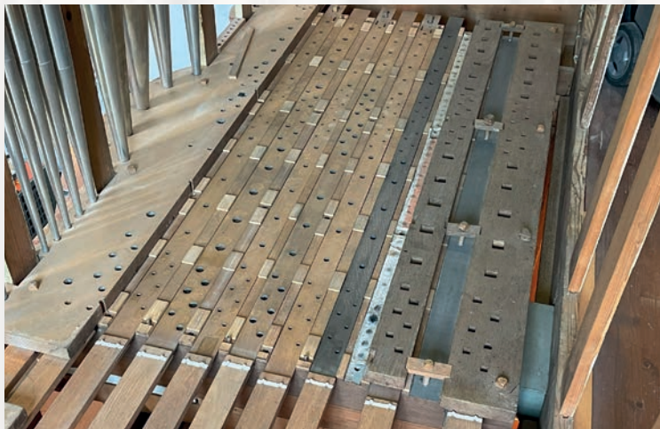
Die Windlade ohne Stöcke, gut zu sehen sind die Schleifen des Hauptwerks, die die Windversorgung der einzelnen Register schalten.
